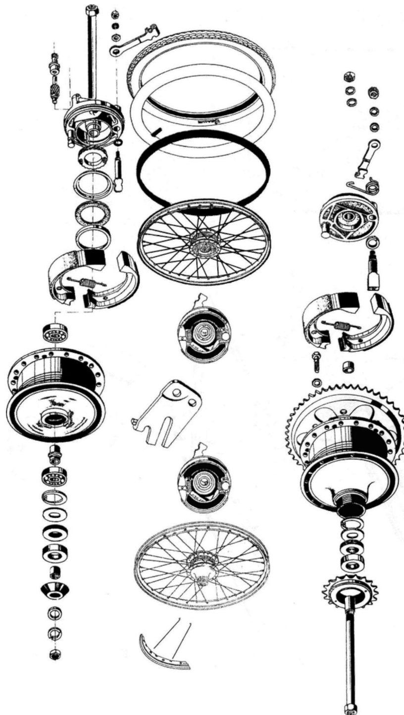
26. ábra Első és hátsó kerék szétszedett állapotban
